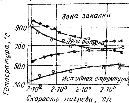
Р и с. 2. Влияние температуры и скорости нагрева на характер структурных изменений: — \circ — ЭИ347; — \square — ЭИ643
