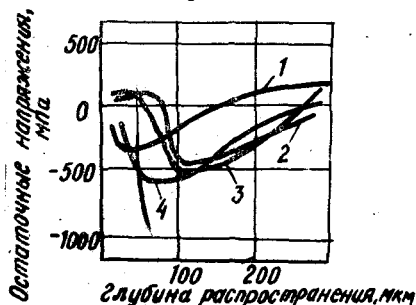
Р и с. 4. Влияние скорости резания на остаточные напряжения: 1 — V = 0,2 м/с; 2 — V = 0,8 м/с; 3 — V = 1,4 м/с; 4 — V = 1,08 м/с
