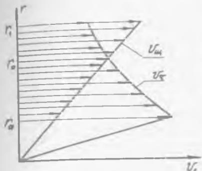
Р и с. 3. Соотношение скорости щетки  $v_{ш}$  и тангенциальной составляющей скорости потока  $v_{т}$
