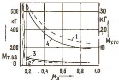
Р и с. 4. Зависимость  $M_{T,ВЗ}$  и  $M_{y,TOOT}$  от  $M_3$  в трехкаскадных АСО с ВТ: 1 -  $M_{y,TOOT}$ , 2 -  $M_{y,TOOT}$ ,  $\mu_1 = 0,2$ ,  $\mu_2 = 0,2$ ; 3 -  $M_{T,ВЗ}$ ,  $\mu_1 = 0,8$ ,  $\mu_2 = 0,9$ ; 4 -  $M_{T,ВЗ}$ ,  $\mu_1 = \mu_2 = 0,2$
