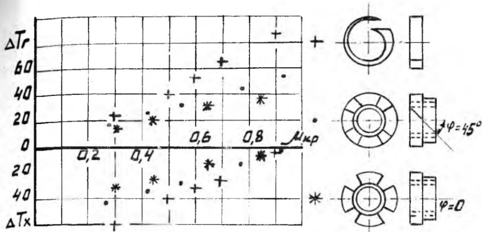
Р и с. 2. Влияние  $M$  на величину  $\Delta T_x$  и  $\Delta T_g$  на критических режимах:  $P_1 = 30$  атм;  $T_1 = 305$  К;  $F_c = 0,1$ ;  $\alpha_c = 0,5$
