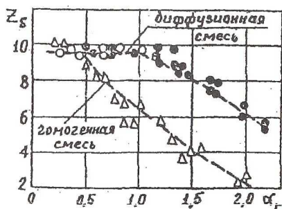
Рис. 4. Изменение безразмерного времени пребывания от \alpha_r ( C_{вх} = 100 м/с)
