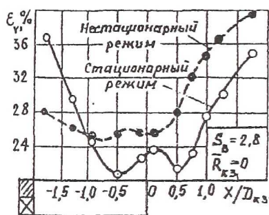
Рис. 1. Изменение интенсивности турбулентности вдоль оси струи
