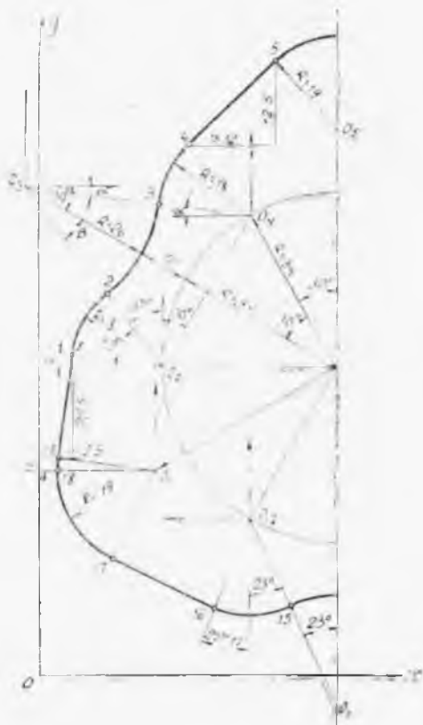
Фиг. 1. Чертеж детали для математического расчета координат опорных точек и определения углов.
