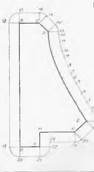
Фиг. 1. Шаблон для проверки профиля \lambda лопатки газовой турбины.
