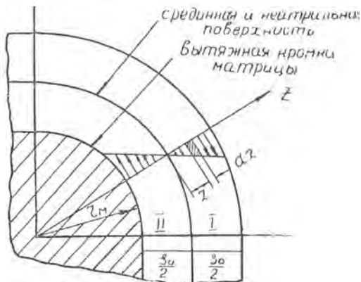
Фиг. 3. Схема для определения M_{\text{внутр.}} возникающего при вытяжке во фланце заготовки.
