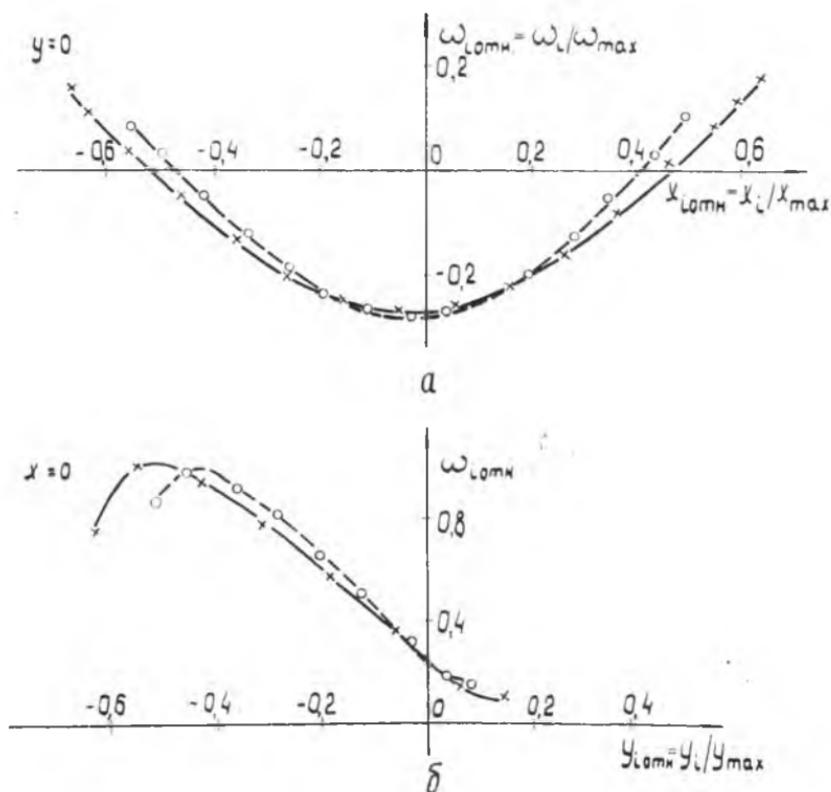
Рис. 3. Распределение перемещений  $\omega_i$  вдоль нейтральной оси (а) и в перпендикулярном направлении (б): о — о — профиль № 1; х — х — профиль № 4
