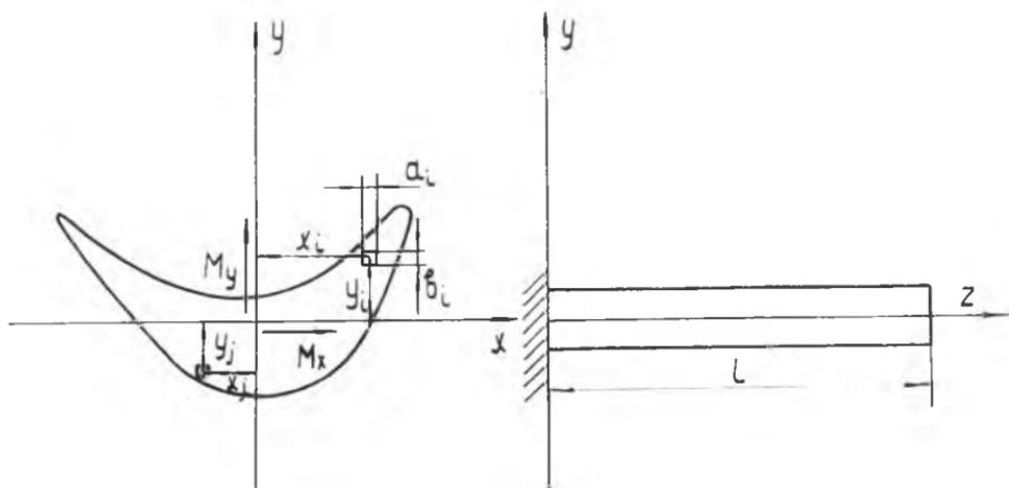
Рис. 1. Форма поперечного сечения лопатки и использованная система координатных осей
