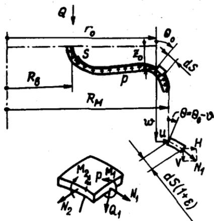
Р и с. 2. Элемент сиффона до и после деформации
