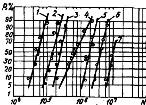
Р и с. 1. Кривые распределения долговечности сильфонов для различных уровней интенсивности напряжений: 1 -  $\sigma_{экр} = 778$  МПа; 2 -  $\sigma_{экр} = 726$  МПа; 3 -  $\sigma_{экр} = 558$  МПа; 4 -  $\sigma_{экр} = 406$  МПа; 5 -  $\sigma_{экр} = 305$  МПа; 6 -  $\sigma_{экр} = 254$  МПа; 7 -  $\sigma_{экр} = 207,5$  МПа
