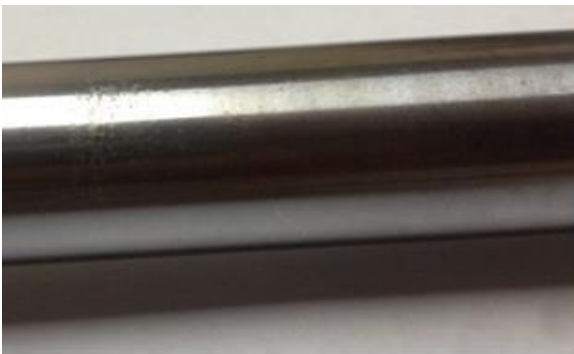
Рис. 5. Проверка адгезии покрытия на детали «Поршень со штоком»
