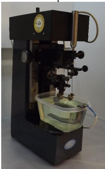
Рис. 3. Установка для автоматического определения остаточных напряжений АСБ-1
