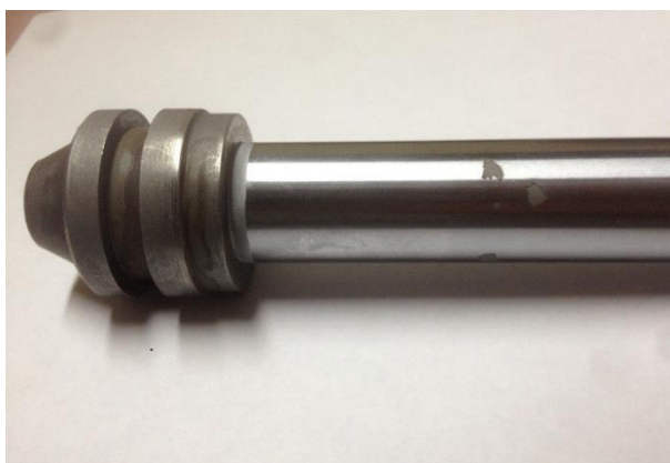
Рис. 1. Отслаивание покрытия на детали «Поршень со штоком» из материала ВТЗ-1
