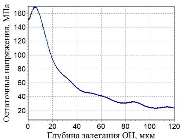
Рис. 2. Эпюра остаточных напряжений в поверхностном слое
