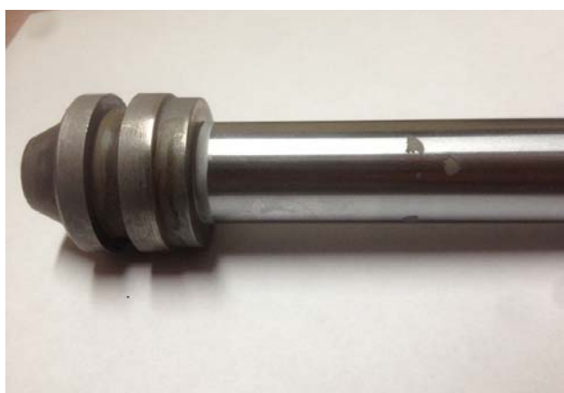
Рис. 1. Шток из сплава ВТ3-1 с дефектом хромового покрытия с дефектами хромового покрытия
