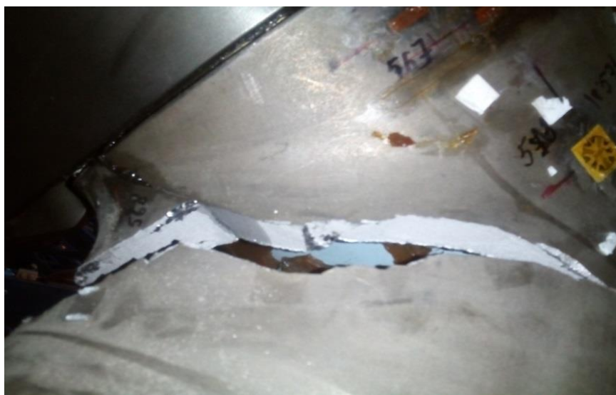
Рис. 2. Место зарождения и роста усталостной трещины
