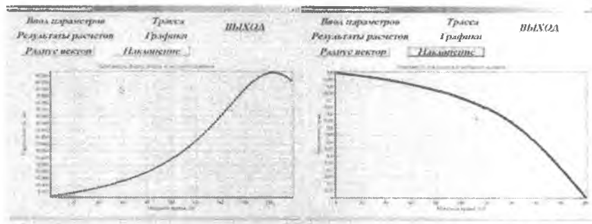
Рис. 1. Окна рабочей программы. Слева приведена зависимость радиуса-вектора от моторного времени, справа – зависимость наклона от моторного времени
