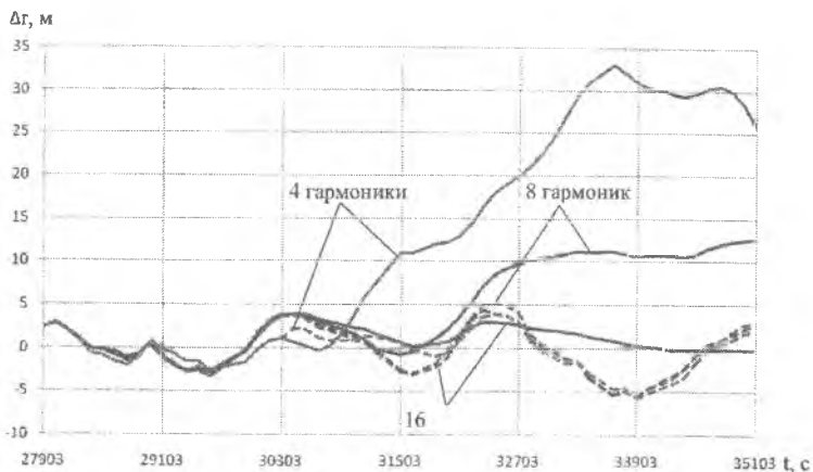
Рис. 1. Погрешности фильтрации в ССН результатов ОНО с периодичностью 2 мин. на интервале 120 мин. по радиусу (КА «Ресурс-ДК», витки 10226-10227)
