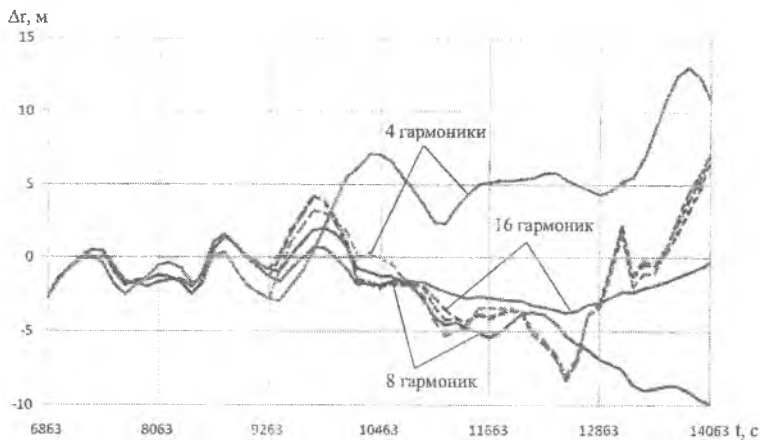
Рис. 2. Погрешности фильтрации в ССН результатов ОНО с периодичностью 2 мин. на интервале 120 мин. по радиусу (КА «Ресурс-ДК», витки 10256-10257)
