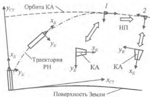
Рис. 3. Изменение направления осей базовой системы координат КА
