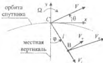
Рис. 1 – Связанная со спутником орбитальная система координат
