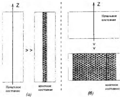
Рис.4 Два случая выработки топлива в ТДУ
