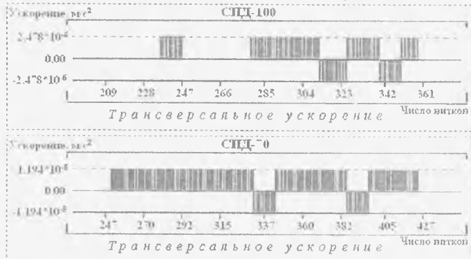
Рис. 4. Циклограммы коррекций большой полуоси и эксцентриситета околокруговой орбиты высотой 350 км с эксцентриситетом 0,0183 (максимум солнечной активности)
