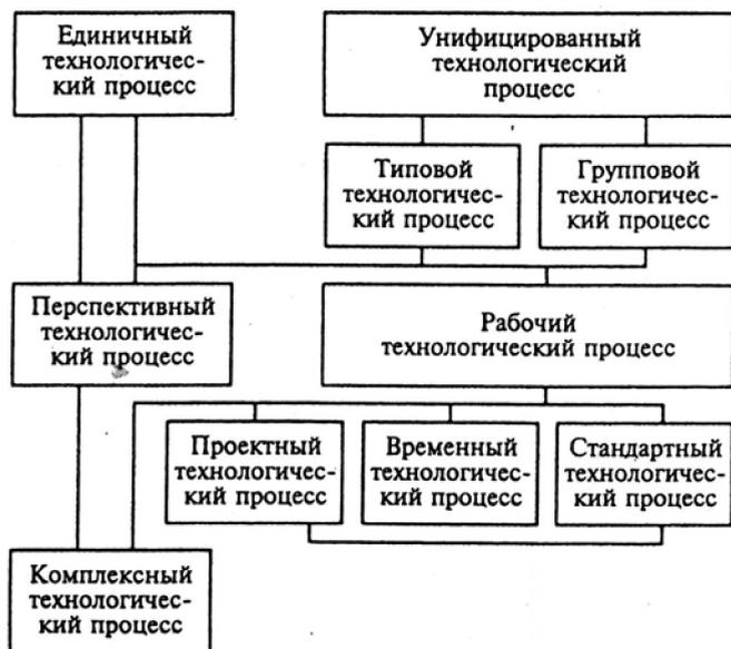
Рис. 4.1. Классификация технологических процессов
