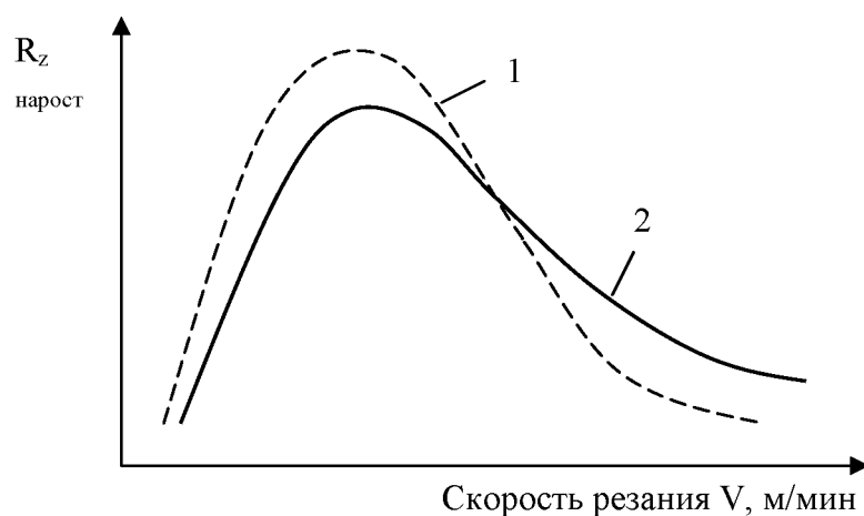
Рис.21 Зависимости величин R_z (кривая 2) и нароста обрабатываемого материала (кривая 1) от скорости резания
