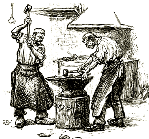
Рисунок 1.31 – Кузнечная сварка, реконструкция XIX века
