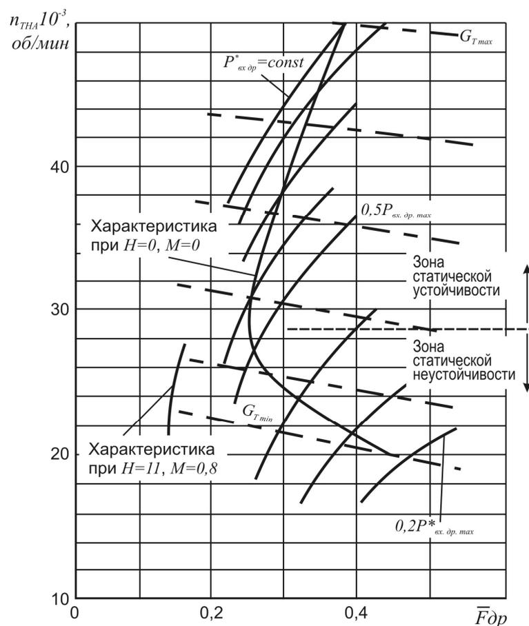
Рис. 3.4.4 Характеристика регулятора частоты вращения ротора ТНА
