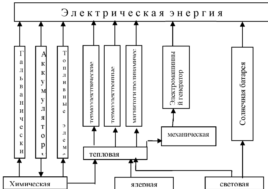
Рис.2.1. Способы получения электрической энергии на борту КА
