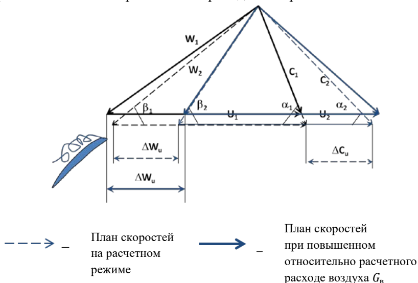
Рис. 1.18. Изменение плана скоростей осевого компрессора при увеличении расхода воздуха относительно расчетного значения
