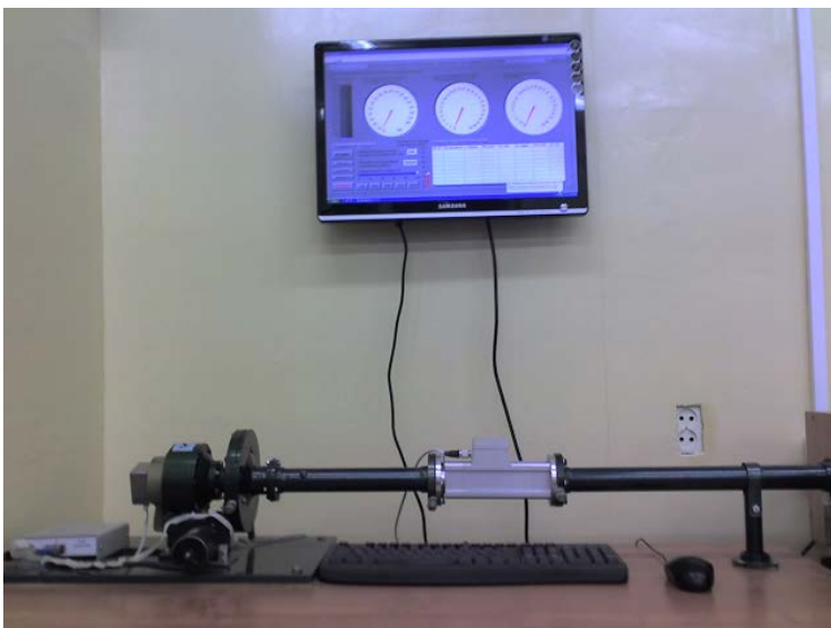
Рис. 2.2. Лабораторная установка для изучения рабочего процесса и снятия характеристик центробежного микрокомпрессора [5]
