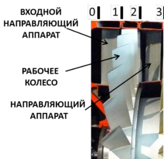
Рис. 1.2. Ступень осевого компрессора и номенклатура сечений
