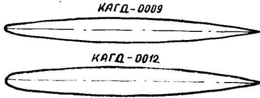
Рис. П2.31. Геометрия профилей серии КАГД 00
