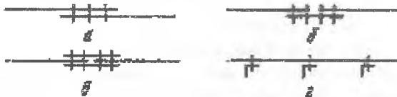
Рисунок 2.1. Виды клепаных швов: а – внахлестку; б – встык с одной накладкой; в – встык с двумя накладками; г – стрингерные
