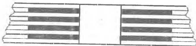
Рисунок 6.4. Армирование материала в зоне отверстия
