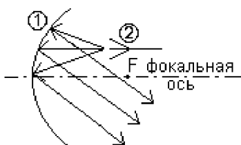
Рис.107 Отклонение луча в параболическом отражателе
