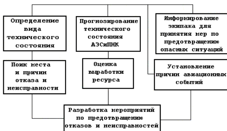
Рис. 2.2 Эксплуатационные задачи технической диагностики
