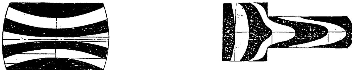
Рис.6 Неравномерность деформации при осадке и прессовании
