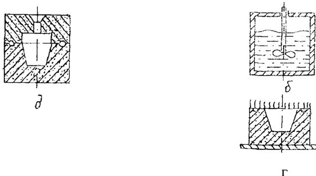
Рис. 1. Схема процесса изготовления керамической формы.
