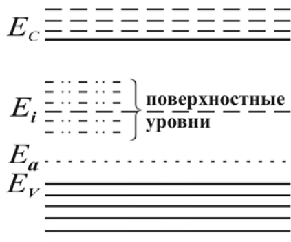
Рис. 1.13. Положение энергетических уровней в области поверхности полупроводника
