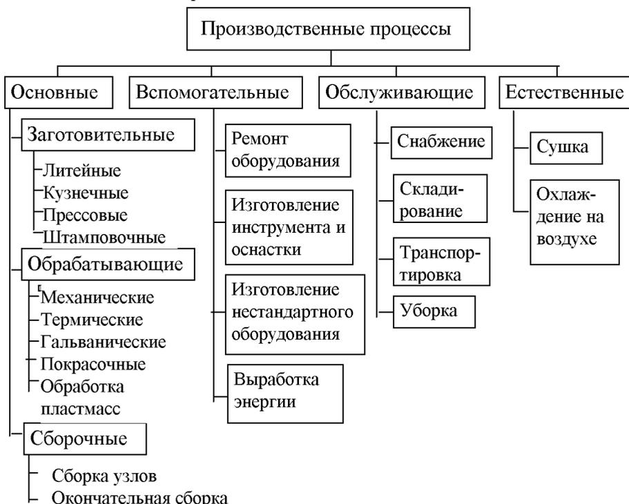
Рис.43. Структура производственного процесса
