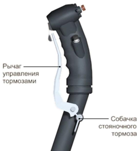
Рисунок 3 – Ручка управления циклическим шагом
