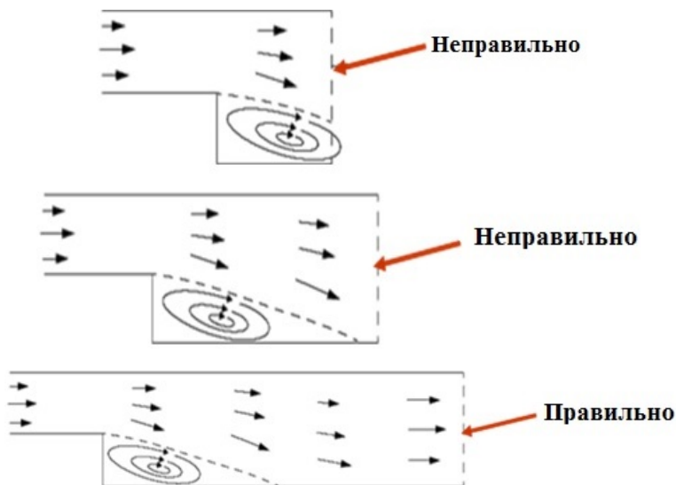
Рисунок 2.7 – Влияние точности задания граничного условия на структуру потока
