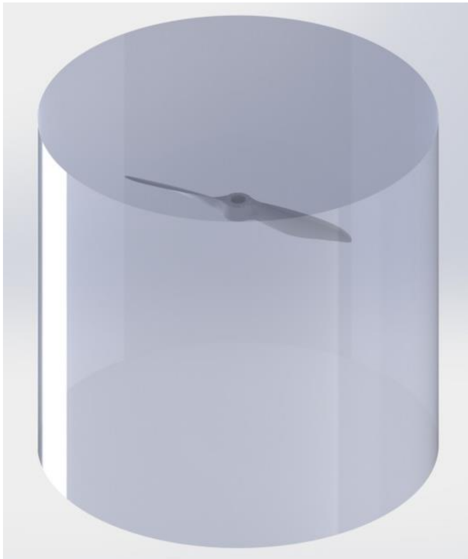
Рисунок 1 – Трехмерная модель винта внутри участка аэродинамической трубы
