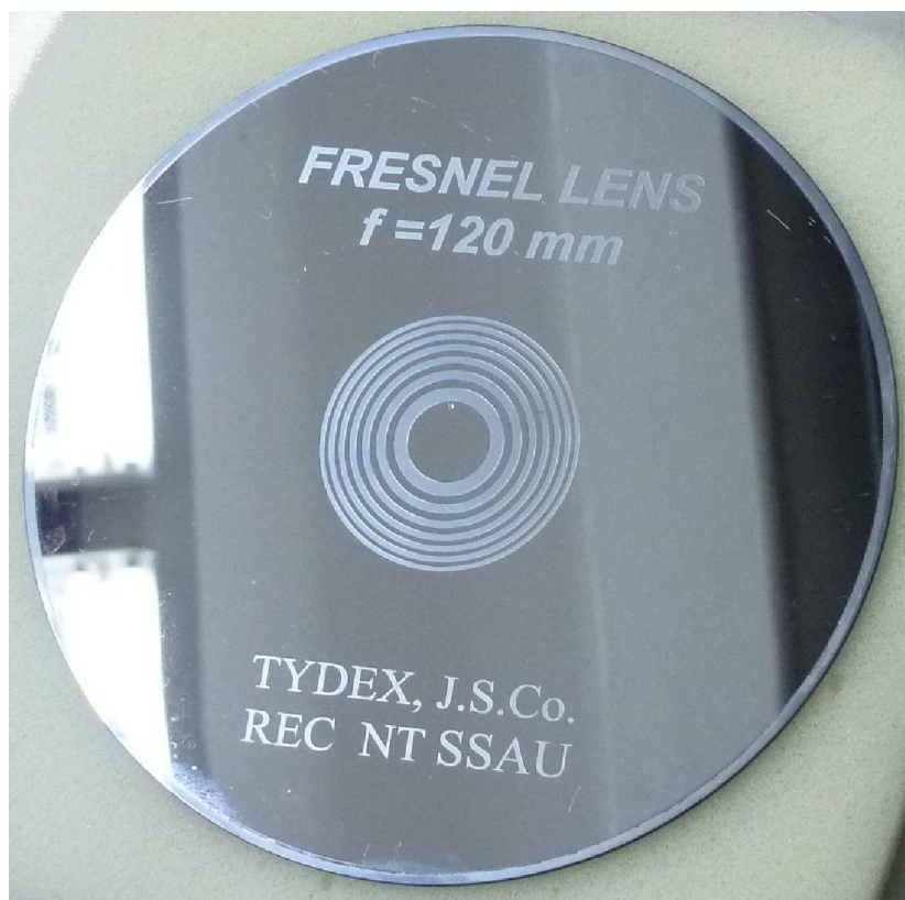
Рис. 2.4. Внешний вид изготовленной бинарной дифракционной линзы
