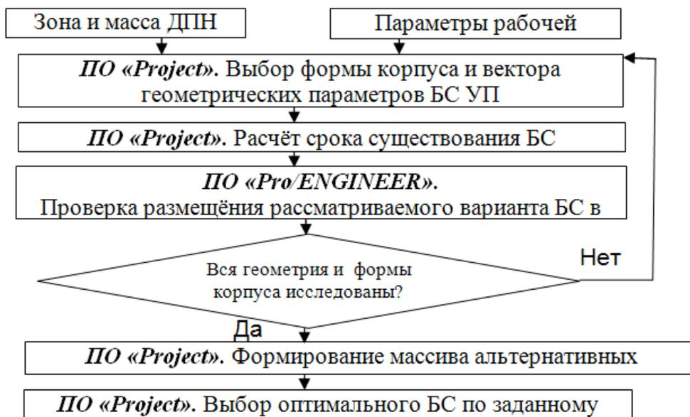
Рисунок 3.139 – Блок-схема алгоритма выбора проектных параметров БС УП
