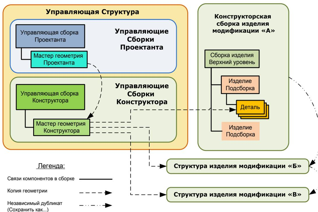
Рисунок 1.23 - Схема проекта
