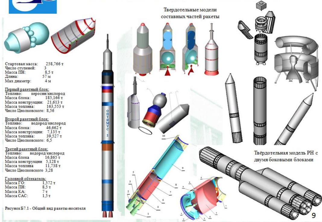
Рисунок 2.11 – Этапы разработки твёрдой модели РН
