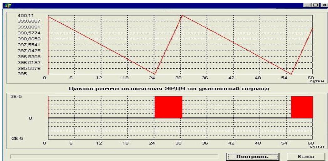
Рисунок 3.163 – Циклограммы управления параметрами движения спутника
