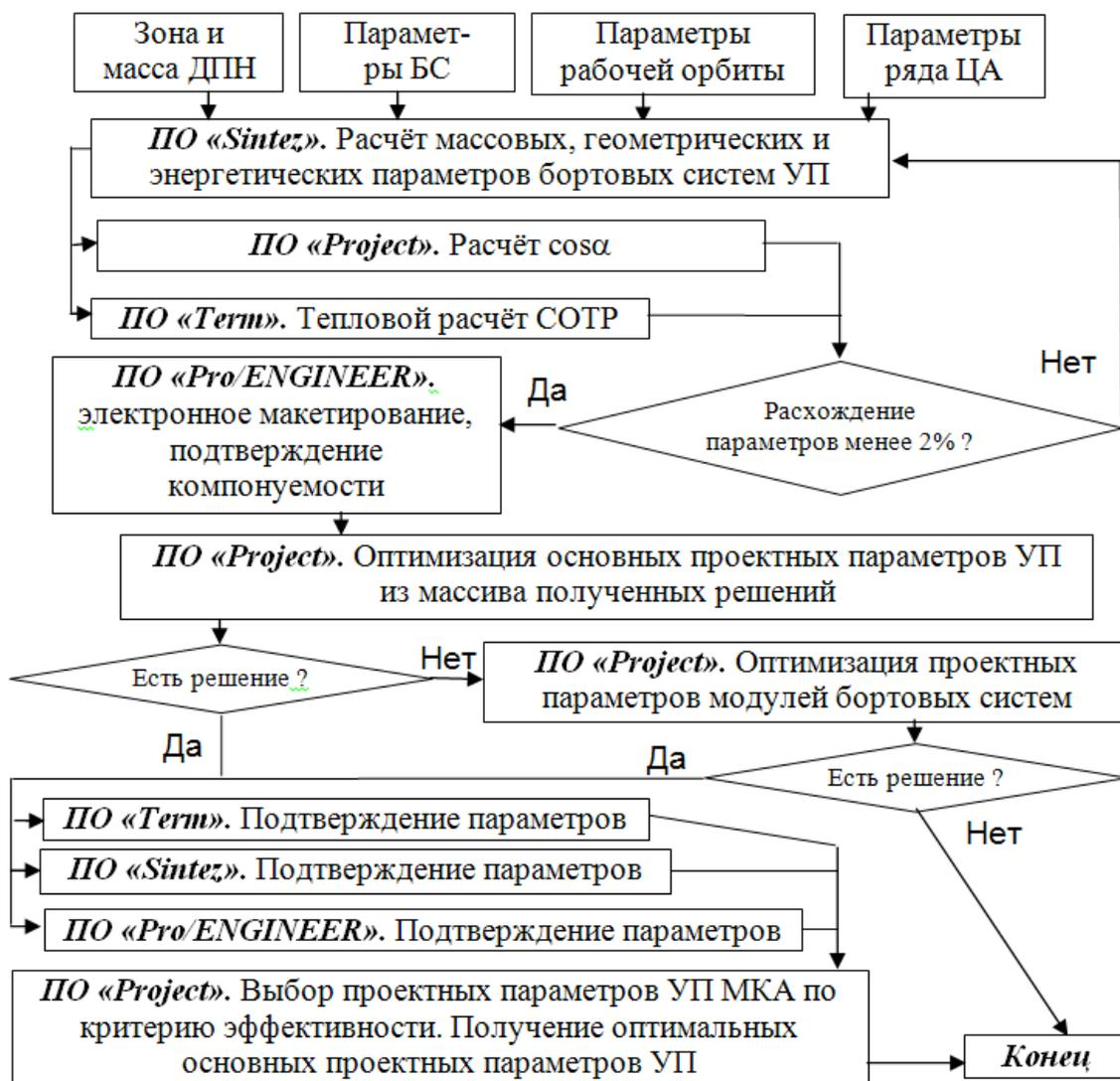
Рисунок 3.140 – Блок-схема алгоритма выбора проектных параметров УП МКА
