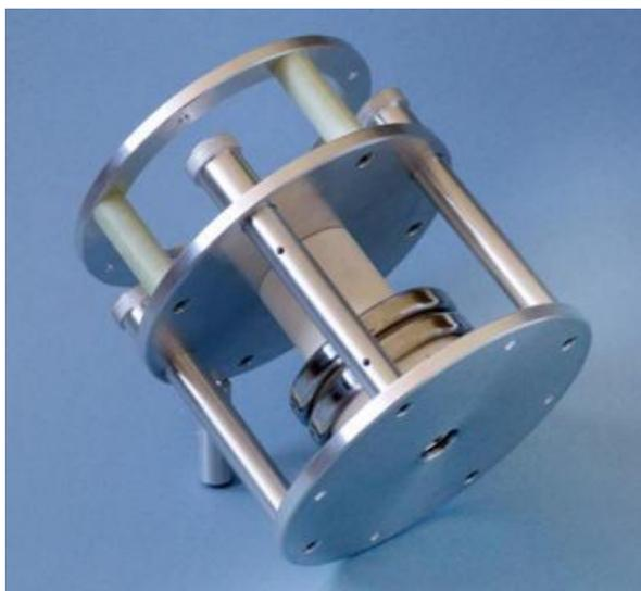
Рисунок 2.63 – Опытный ионный двигатель DS4G
