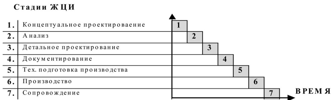
Рисунок 1.15 – Последовательная технология проектирования
