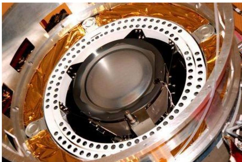
Рисунок 2.63 – Общий вид ионного двигателя NSTAT (XIPS-30)
