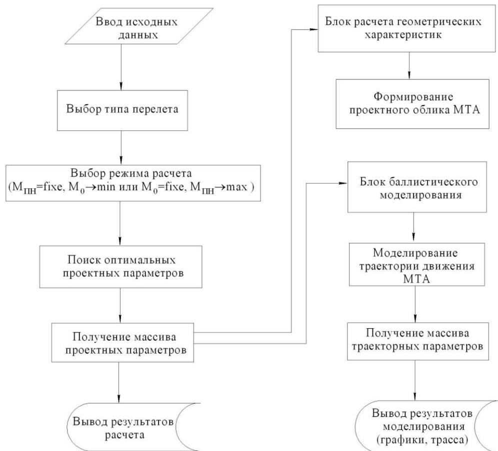
Рисунок 3.97 – Укрупненная блок-схема алгоритма работы блока проектирования и моделирования функционирования ТКА
