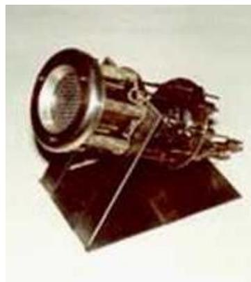
Рисунок 2.60 – ЭРД разработки исследовательского центра им. М.В.Келдыша: стационарный плазменный двигатель Т-100, ионный двигатель 5 СМ
