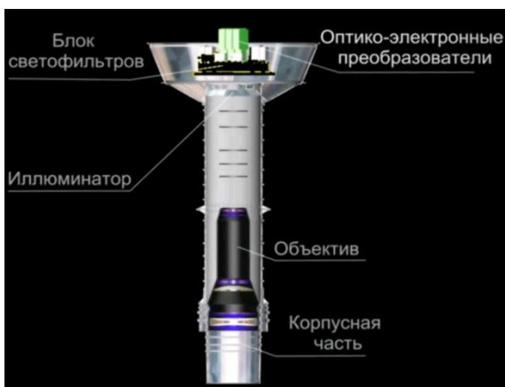
Рисунок 3.71 - Схема оптической системы наблюдения и расположения оптико-электронного преобразователя
