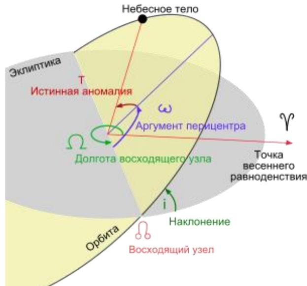
Рисунок 2.85 – Элементы орбиты:  $A$  – большая полуось орбиты;  $e$  – эксцентриситет орбиты;  $\omega$  – аргумент перигея;  $i$  – наклонение орбиты;  $\Omega$  – долгота восходящего узла
