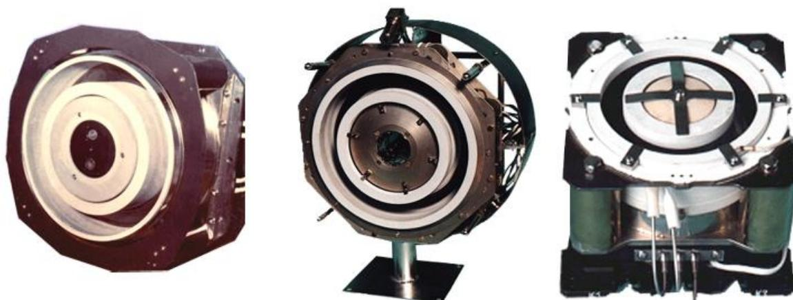
Рисунок 2.59 – Двигатели СПД-200, СПД-290 (Геркулес), СПД-2300
