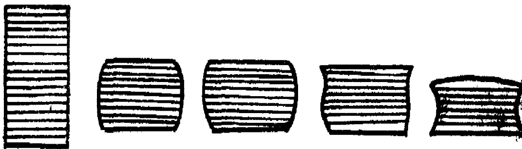
Рисунок 2.7 — Образцы, деформированные с различными скоростями \varepsilon = 0,5 /: слева направо — исходная заготовка; деформация со скоростью соответственно V = 0,001 м/с; V = 25 м/с; V = 50 м/с; V = 100 м/с
