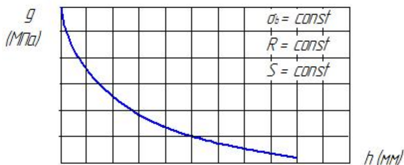
Рис. 2. Зависимость давления эластичной среды от высоты формоблока
