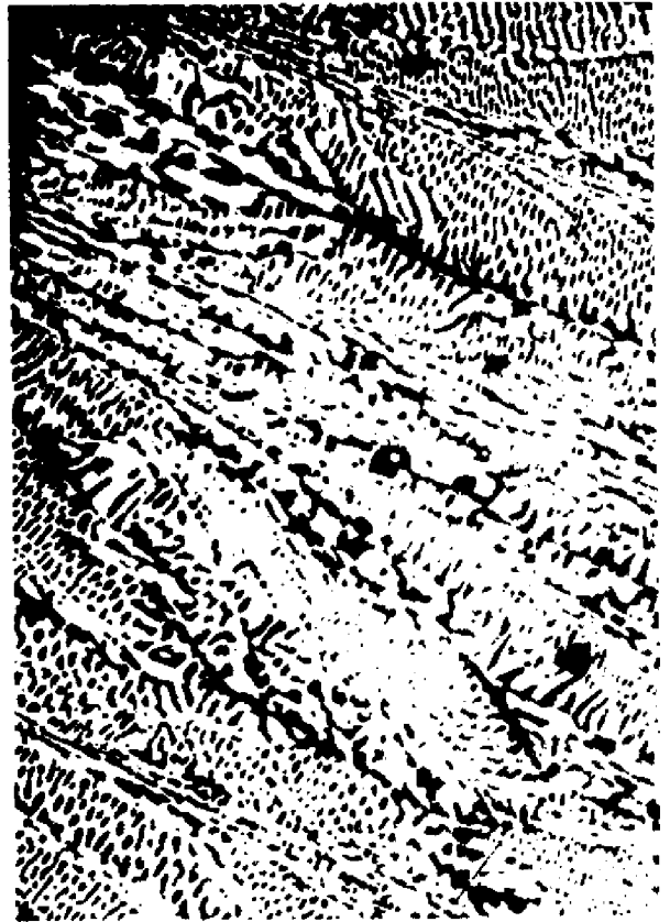
Рис. 8. Ледебурит, х 500-эвтектическая смесь, состоящая из округлых темных включений перлита на светлой основе цементита; содержит 4,3 % С; образуется при t147^{\circ}\text{C} из жидкости
