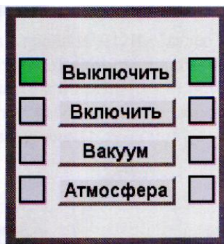
Рис. 6.9 Панель управления установкой и вакуумной системой. Кнопки разблокированы.
