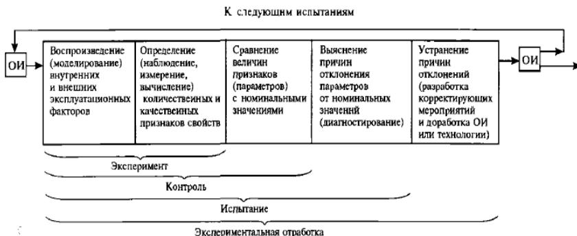
Рис. 1.3 – Обобщенная схема экспериментальной отработки
