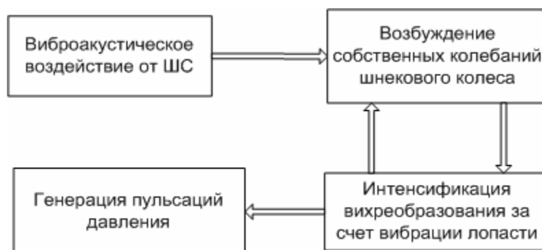
Рисунок 2.4. Схема акустико-вихревого резонансного возбуждения лопасти шнека
