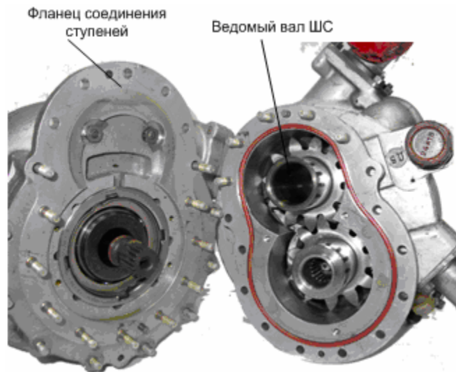
Рисунок 2.2. Шнекоцентробежная ступень (слева) и шестеренная ступень (справа)
