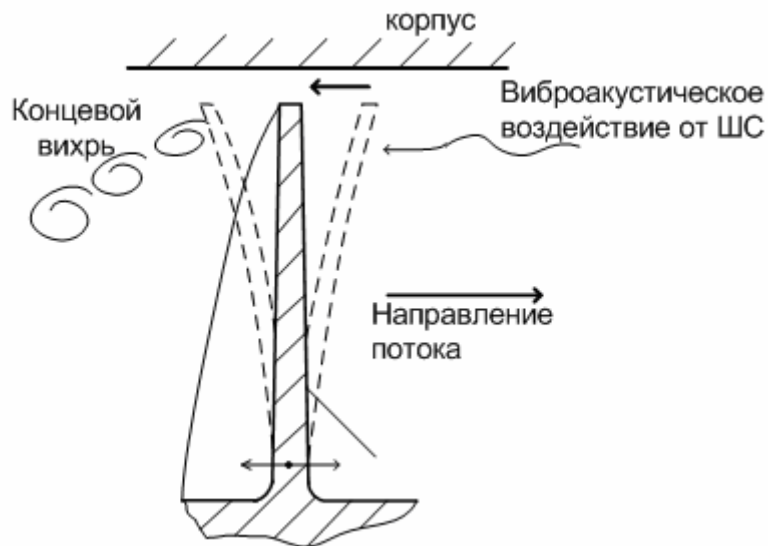
Рисунок 2.5. Колебания шнека вследствие отрыва концевой вихря и виброакустического воздействия от ШЦ
