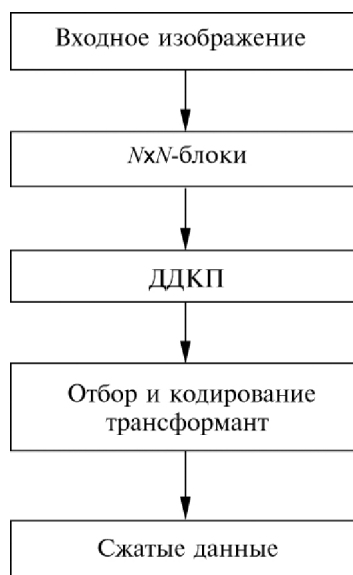
Рис. 4.1. Схема метода кодирования с преобразованием
