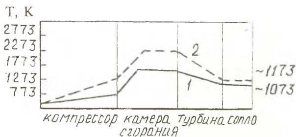
Рис.1.3. Прогноз роста рабочих температур в авиационных ГТД: 1 - в современных двигателях; 2 - в двигателях будущего
