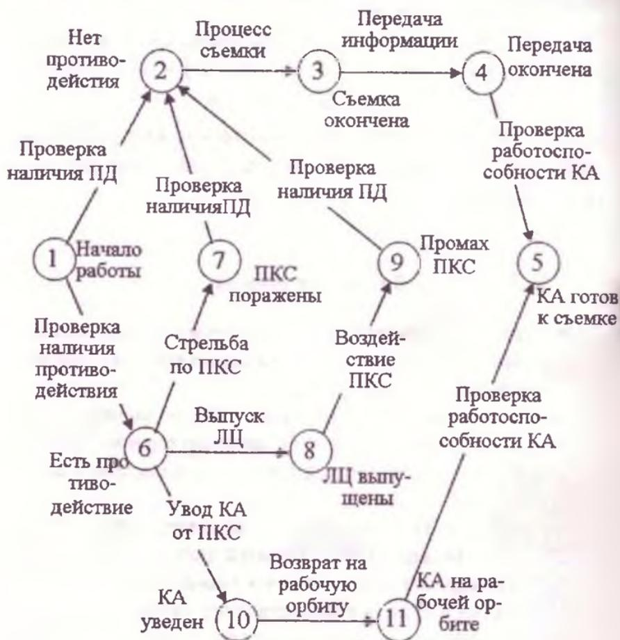
Рис. 3.3. Сетевая модель целевой работы космического аппарата наблюдения с противодействием
