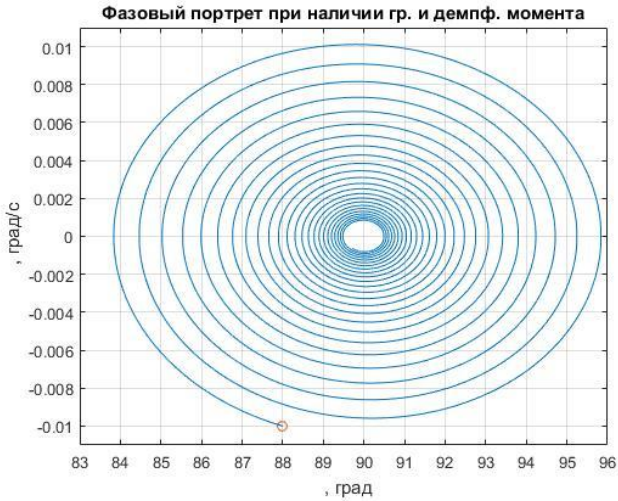
Рисунок 2.3 – Пример фазового портрета при учёте гравитационного момента и наличии демпфирующего момента, продолжительность демпфирования T = 89702 с
