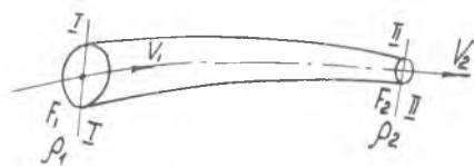
Рис. 2. Изменение параметров воздуха в трубке тока
