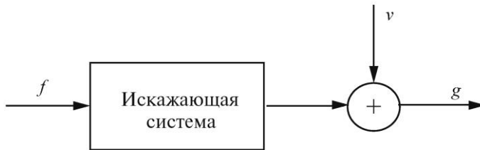
Рис. 2.1. Модель наблюдения полезного сигнала
