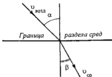
**Рис. 3.59.** Преломление светового луча на границе воздуха и другой оптической среды
